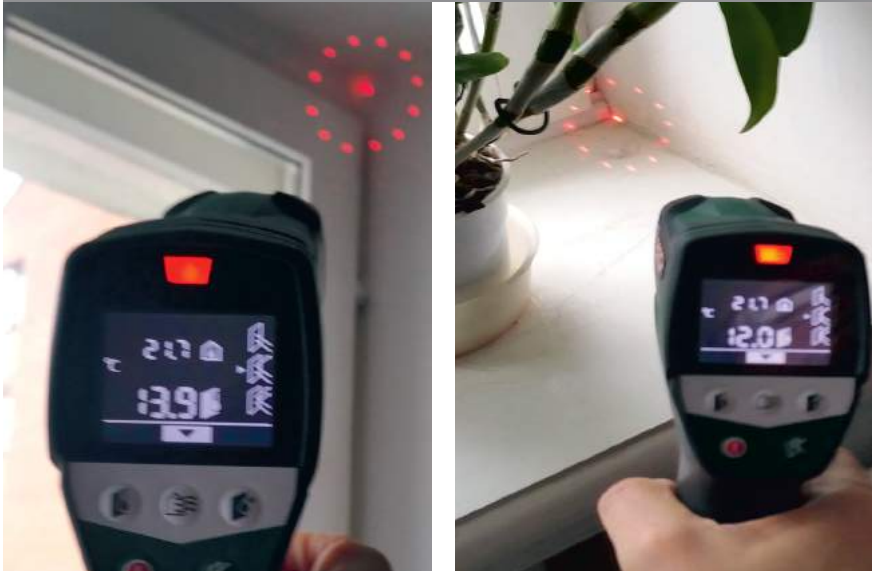
Примеры: результаты измерения температуры поверхности стен
