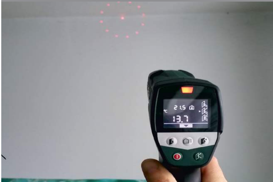
Примеры: результаты измерения температуры поверхности стен
