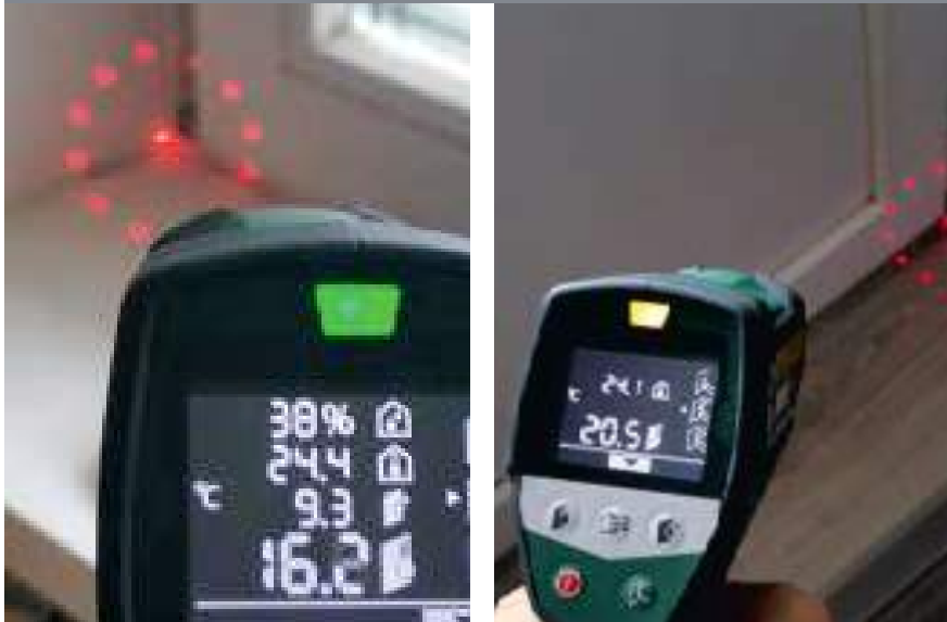
Примеры: результаты измерения температуры поверхности стен
